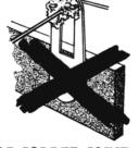
COLD SOLDER JOINT CONNECTION MOVED WHILE COOLING
