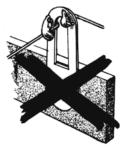
COLD SOLDER JOINT CONNECTION INSUFFICIENTLY HEATED
