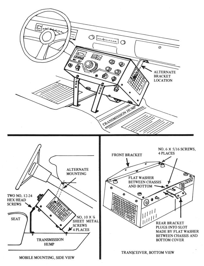
FIGURE 1. MOBILE MOUNTING ON TRANSMISSION HUMP UNDER DASH
