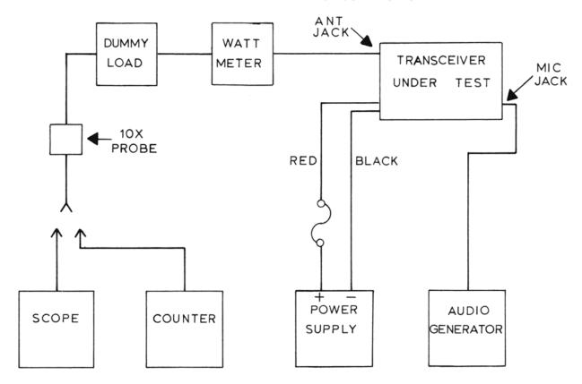
FIG. 5-3 RECEIVER TEST CONNECTION
