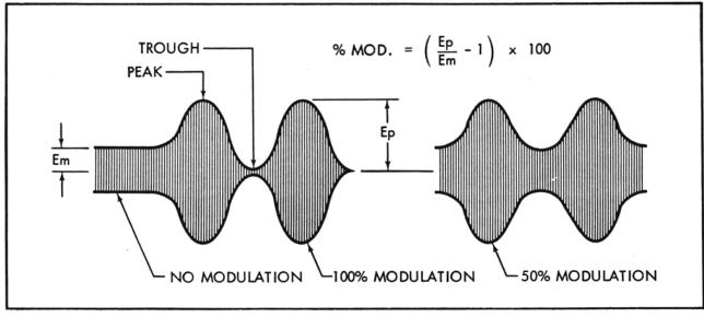
Fig. 3 DIRECT MODULATION MONITOR
