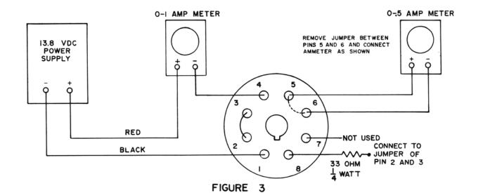
TEST POWER CABLE CONNECTION
