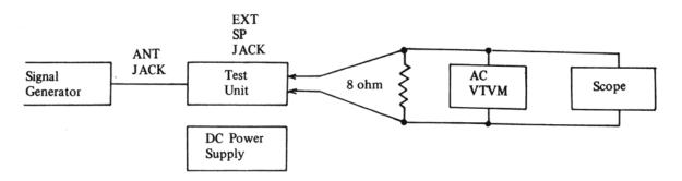
RECEIVER ALIGNMENT SETUP
