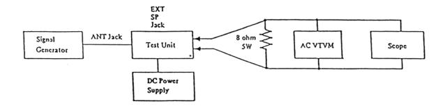
RECEIVER ALIGNMENT SETUP
