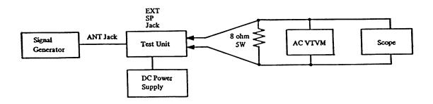
RECEIVER ALIGNMENT SETUP
