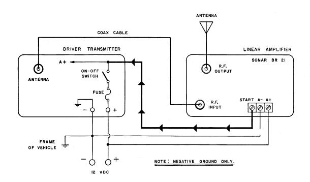
FIG. IC INSTALLATION DIAGRAM
